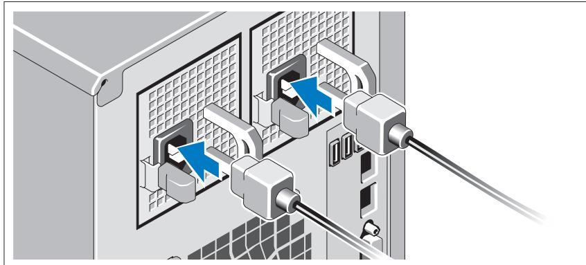
Podłącz odpowiedni kabel (lub kable) zasilania do komputera oraz odpowiedni kabel zasilania do monitora, o ile jest używany.
