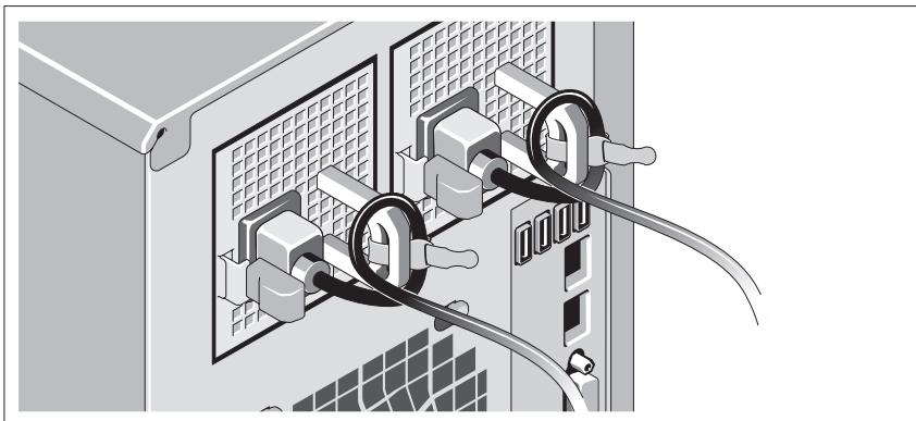
Bilden Sie mit dem Systemnetzstromkabeln wie abgebildet eine Schlaufe und sichern Sie sie mit dem Band.
