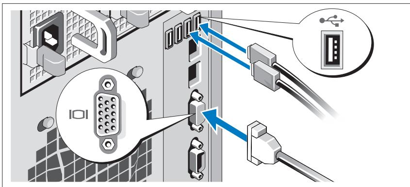
Подключите клавиатуру, мышь и монитор (дополнительно).
