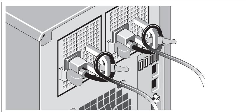
Repliez le ou les câbles d'alimentation système comme indiqué dans l'illustration suivante et fixez-le(s) avec la bande fournie.
