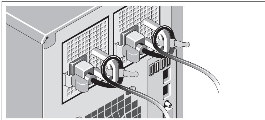
Zegnij kabel (kable) zasilania komputera w pętlę w sposób przedstawiony na rysunku i zamocuj kabel (kable), używając załączonej opaski.
