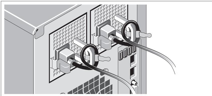
Κάμψτε το καλώδιο (ή τα καλώδια) τροφοδοσίας του συστήματος σε μορφή βρόχου, όπως φαίνεται στο σχήμα, και χρησιμοποιήστε το συνοδευτικό λουρί για να στερεώσετε το καλώδιο (ή τα καλώδια) στο βραχίονα.
